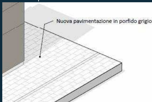
Pavimentazione cortile interno
